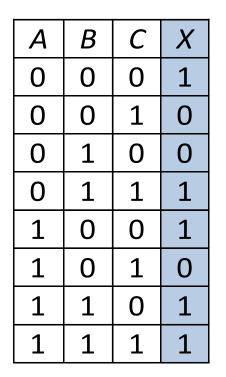
$$X = \overline{A} \cdot \overline{B} \cdot \overline{C} + \overline{A} \cdot B \cdot C + A \cdot \overline{B} \cdot \overline{C} + A \cdot B \cdot \overline{C} + A \cdot B \cdot \overline{C}$$
